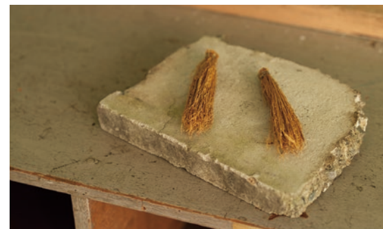
繭糸の始まりを見つけるための「みごぼうき(実子簀)」 Brushes to locate the starting point of the cocoon thread
